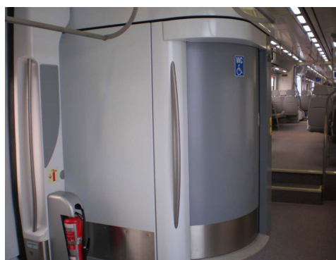
Aseo universal en la zona de piso bajo
