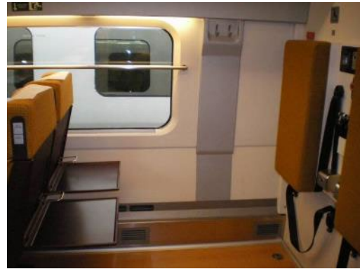
Plaza H con reposacabezas cervical, cinturón de seguridad y anclajes
