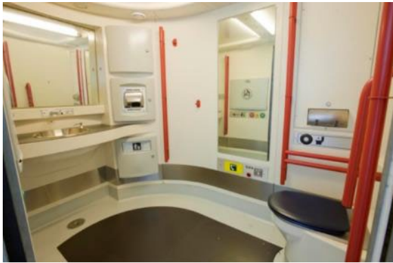
Aseo universal: contraste de las barras de sujeción, tapa inodoro, pulsadores de apertura y cierre y bloqueo de puerta, pulsador de alarma y pictografía
