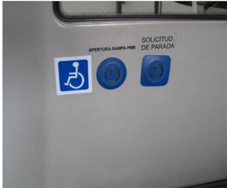
Pulsadores de parada y rampa
