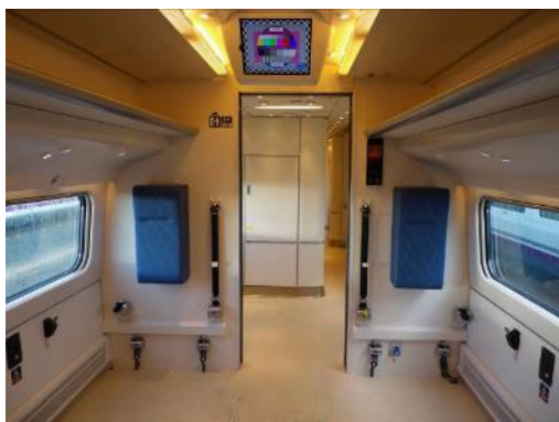
Detalles de las plazas H con apoyo cervical, anclajes y cinturón de seguridad
