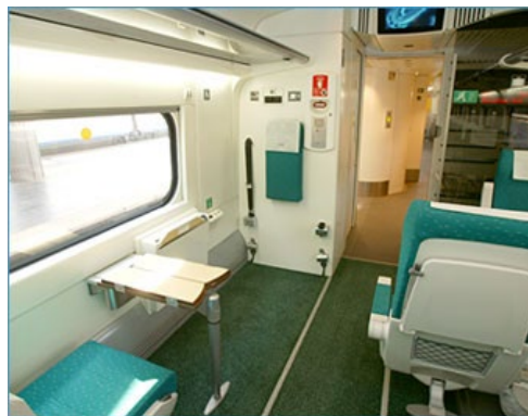
Detalle de la plaza H para usuarios en silla de ruedas. Al fondo se observa el aseo universal
