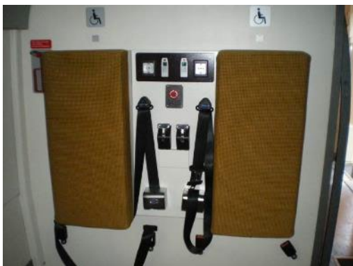
Detalle de las plazas para usuarios en silla de ruedas con mesita, anclajes, cinturón de seguridad, pulsador de alarma, apoyo cervical y enchufes
