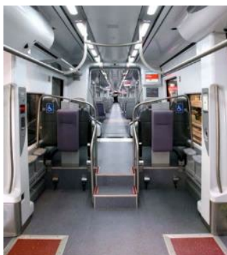
Plazas H para usuarios en silla de ruedas, con anclajes, cinturón de seguridad y apoyo cervical
