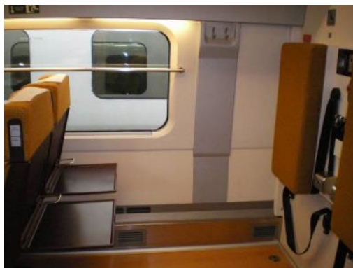
Detalle de las plazas para usuarios en silla de ruedas con mesita, anclajes, cinturón de seguridad, pulsador de alarma, apoyo cervical y enchufes
